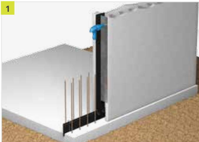
Uklonite sve folije s PENTAFLEX FTS® elemenata. Krilce bez zaštitnog sloja prisloniti s čeone strane na vanjsku ljuštu i bušiti kroz otvore koji su tvornički probušeni u elementu.
