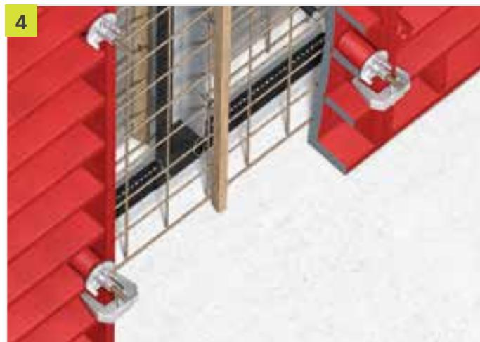
Spoj OBS elementa na PENTAFLEX KB® vrši se preklapanjem od najmanje 50 mm i čvrstim međusobnim pritiskom limova zaštićenih površina. Kod temperatura ispod +5 °C površine spojeva moraju se zagrijati.
