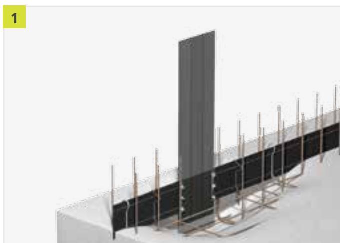
Ukloniti folije u donjem području brtvene trake kao i na unaprijed montiranom FBA elementu. Spajanje FBA elementa na PENTAFLEX KB® koji se nalazi u podnoj ploči, vrši se preklapanjem od najmanje 50 mm i međusobnim čvrstim pritiskanjem. Kod temperatura ispod +5 °C površina spojeva mora se zagrijati. Mjesto spoja osigurati s pomoću spojnog osigurača.
