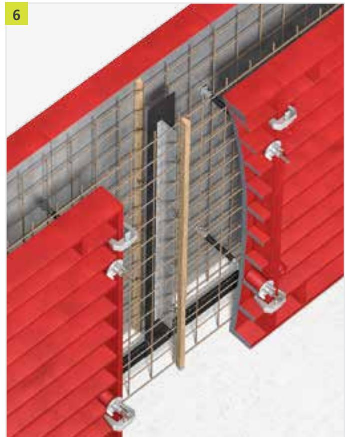
Svako mjesto spajanja mora se osigurati pomoću dvije križne kopče. Prije nego što se zidna oplata zatvori, mora se postaviti prikladna rubna zaštita, npr. trapezna letvica po mjeri u osi montažnih limova OBS elementa.
