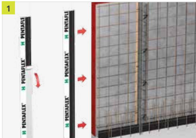
Postaviti vanjsku oplatu i na poziciji radne reške položiti trapeznu letvicu. Položiti vanjsku armaturu. Koristiti vodonepropusne držače razmaka! ABS element postaviti preko PENTAFLEX KB® reške između poda i zida i povezati žicom ili zavariti s armaturom. Skinuti s obje strane zaštitni papir u području prvog segmenta za betoniranje i lim umetnuti sve do graničnika u oplatu.
