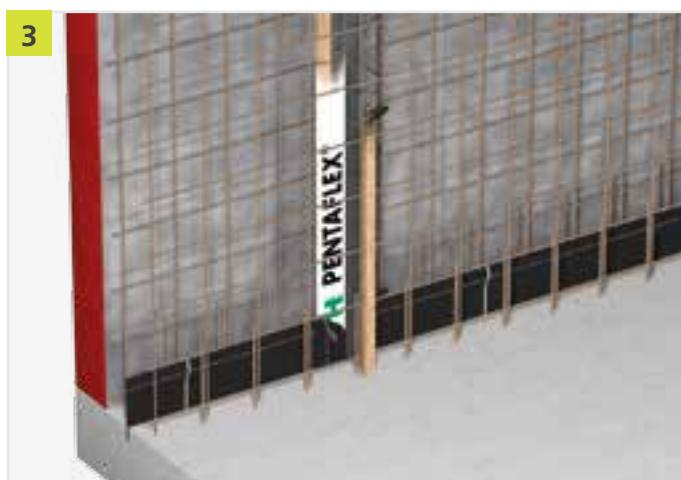
Namjestiti unutarnju armaturu i spojiti s ABS elementom (čizma za vezanje, zavarivanje). Pričvrstiti trapeznu letvicu i zatvoriti oplatu. Koristiti vodonepropusne zatezače.
