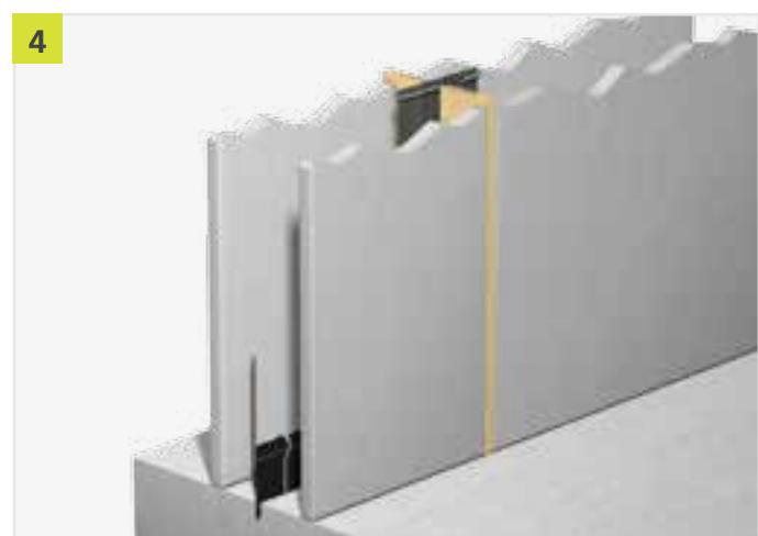
Postavljanje sljedećeg polumontažnog šupljeg zidnog elementa. Zapuniti polumontažne šuplje zidne elemente betonom. Pokrivanje reški na površini u skladu sa zahtjevima.
