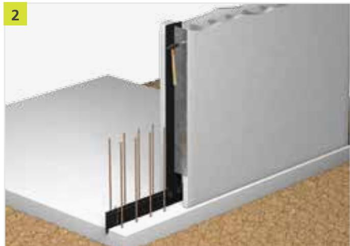
PENTAFLEX FTS® element mora se fiksirati s pomoću udarnih plastičnih sidara koja su dio isporuke.
