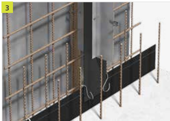
Namještanje OBS elementa u oplati zida između vanjskog i unutarnjeg sloja armature. Učvršćenje se vrši s pomoću žice za vezanje armature. Žica se provodi kroz otvore koji postoji u montažnim limovima i onda se učvršćuje na armaturi. OBS element u svom se položaju mora fiksirati na način da razina montažnih limova nepomično leži na planiranom mjestu ciljane reške; razina brtvljenja onda se nalazi točno paralelno s površinom oplate u osi brtvljenja reške između poda i zida.
