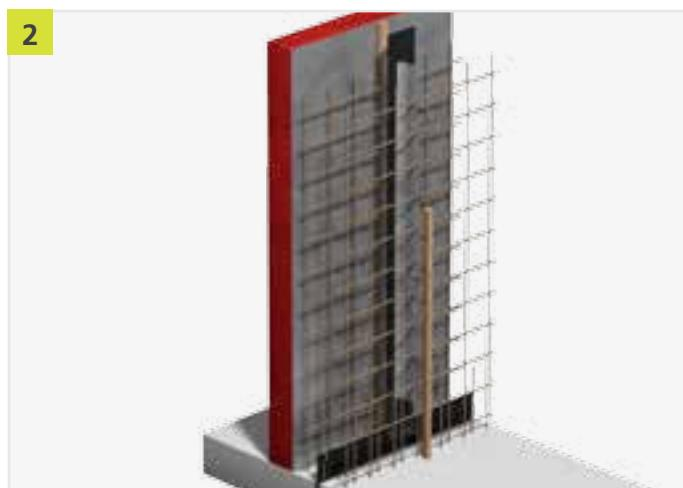
Ugradnja prikladne letvice visine  $c_{\text{nom}}$  na oplatu, točno na mjestu na kojem treba nastati ciljana reška (razina montažnog lima).
