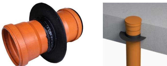
Ako se ne koriste gotovi elementi prolaza, potrebno je prije betoniranja (1 – 3 h), a na mjestima gdje će cijevi ili kablovi izlaziti iz betona po obujmu istih nanijeti bubreći kit (npr. Sika Swell S-2) širine 1,5 cm. Po skidanju oplate ista mjesto premazati smjesom XYPEX Concentrate.
