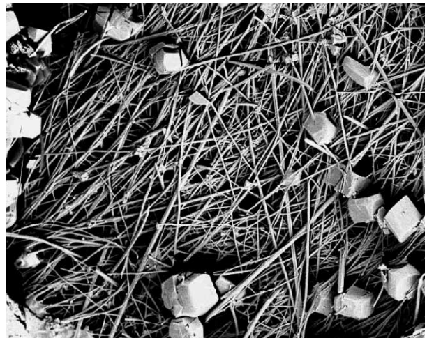
BETON TRETIRAN XYPEX-OM (30% SMJESA CEMENTA I LETEĆEG PEPELA)
