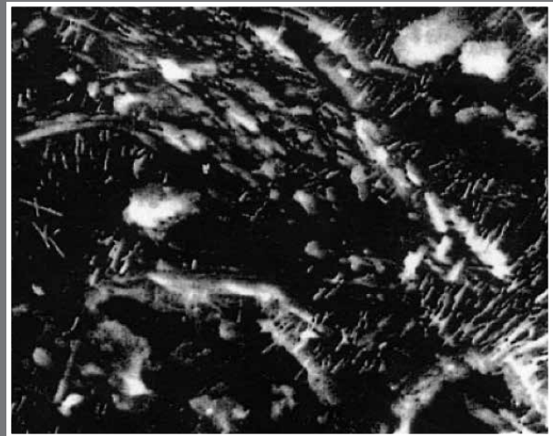
BETON TRETIRAN XYPEX-OM
